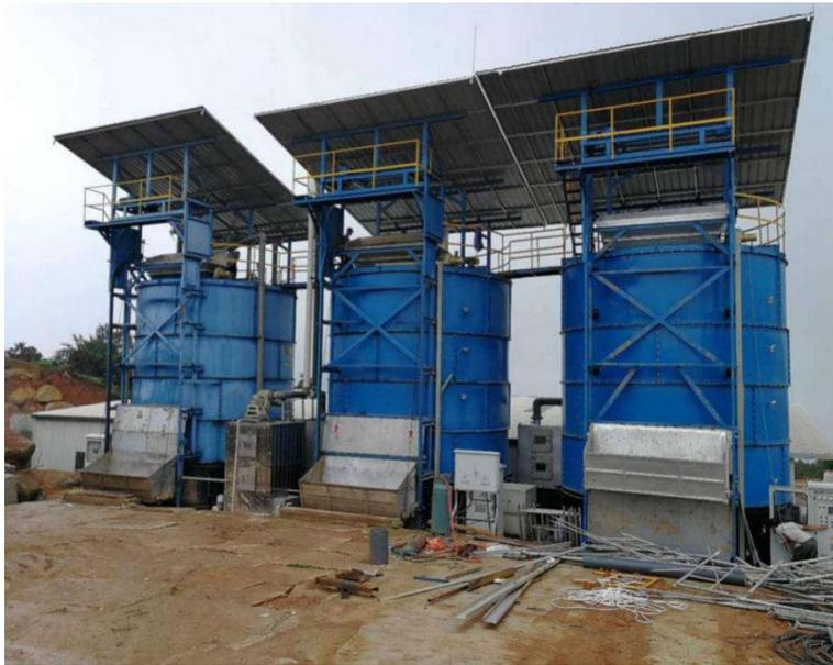
图 55 畜禽粪便罐式发酵设备
